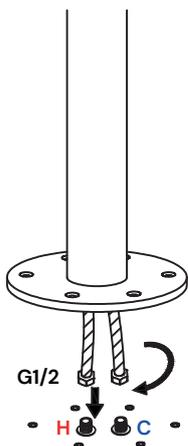
d) Skruva fast fixeringskruvarna ordentligt (medföljer).
